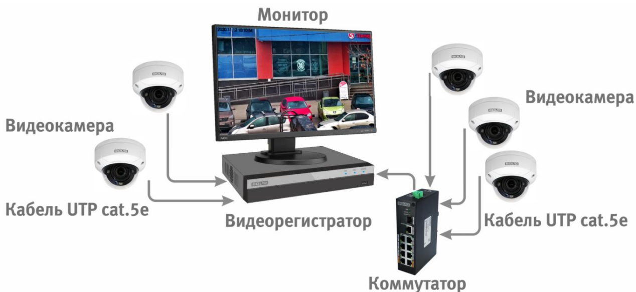
Рисунок 6.5 – Схема подключения видеокamеры к видеорегистратору
