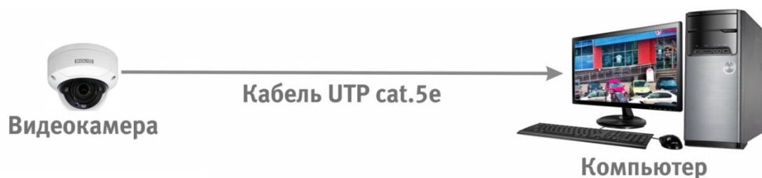
Рисунок 6.3 – Схема подключения видеокamеры к компьютеру
