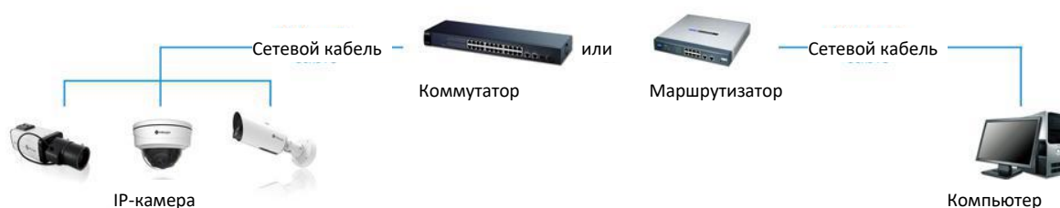
Рисунок 2-1-2 Подключение через коммутатор или маршрутизатор
